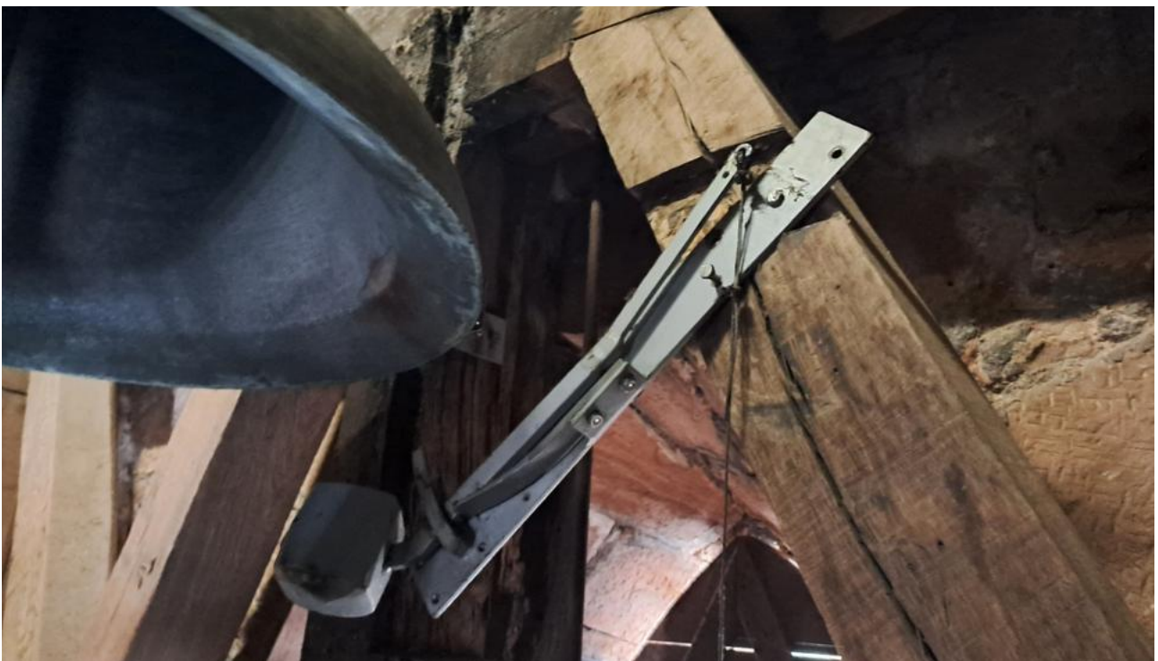
Auslöser für eine ganze Reihe von Fehlern: ein Stundenschlag war aus der Spur geraten.
